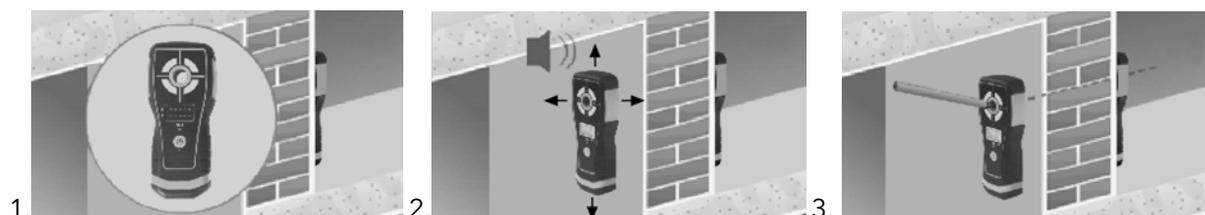
1. Coloque massa adesiva suficiente fornecida em cada um dos 4 entalhes em forma de arco na parte inferior do transmissor. Posicione firmemente o transmissor no ponto de perfuração necessário na parede ou teto. Certifique-se de que a abertura do auxiliar de marcação [1] do transmissor esteja exatamente no ponto de perfuração necessário e que o transmissor esteja paralelo à superfície da parede ou teto.
