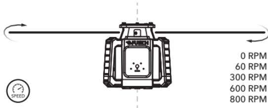
Cet appareil dispose de plusieurs vitesses de rotation. 0, 60, 300, 600 et 800 tr/min. La vitesse de rotation par défaut est de 600 tr/min.
