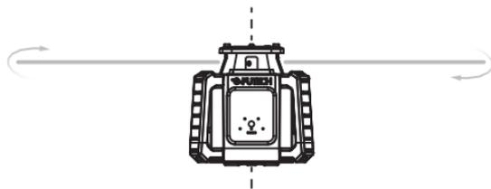
Cet appareil peut également projeter un « fil à plomb » du sol au plafond, ou vice versa, via le point d'aplomb haut [02] et le point d'aplomb bas [08].
