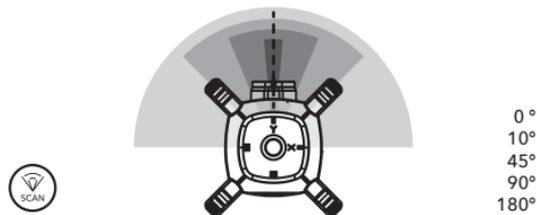
La fonction scan permet de restreindre le faisceau laser à un angle plutôt qu'à un cercle complet de 360°. Cela crée un segment très lumineux qui augmente la visibilité pour l'œil humain.
