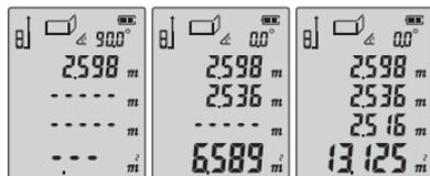
Repita estos pasos para más paredes. Pulse el botón de borrado - apagado **[7]** para eliminar y borrar los resultados de las mediciones anteriores. Así podrá realizar una nueva medición.
