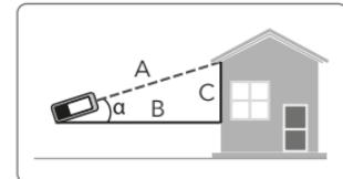
Questa funzione consente all'utente di misurare l'altezza e la distanza orizzontale di un triangolo rettangolo sulla base di una singola misura dell'ipotenusa e dell'angolo di inclinazione misurato.
