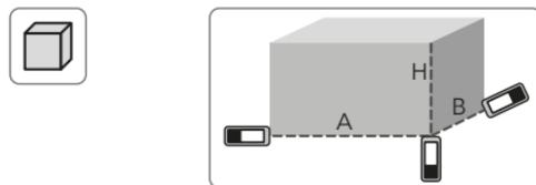
Questa funzione consente di calcolare la superficie totale delle pareti di una stanza misurando una sola volta l'altezza e poi la larghezza delle singole pareti.
