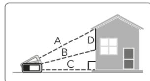
Questa funzione consente di calcolare l'altezza di una linea ausiliaria all'interno di un triangolo utilizzando tre misurazioni manuali della distanza.
