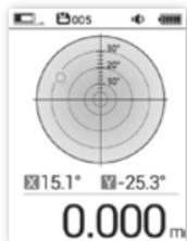
La distanza misurata viene visualizzata nella riga dati principale [A], con i valori di inclinazione X e Y visualizzati sopra di essa sullo schermo.
