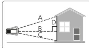
Questa funzione consente di misurare il terzo lato di un triangolo tramite calcolo automatico usando il teorema di Pitagora.
