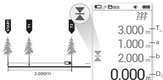
Quando si raggiunge il punto di picchettamento, il valore nella riga dati principale [A] sarà 0, indicando che il dispositivo si trova esattamente sul punto bersaglio.
