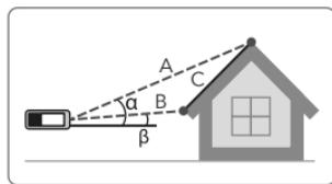
Questa funzione è utile per misurare la differenza di altezza e la distanza inclinata tra due punti, ad esempio dalla cresta alla grondaia di un tetto inclinato.
