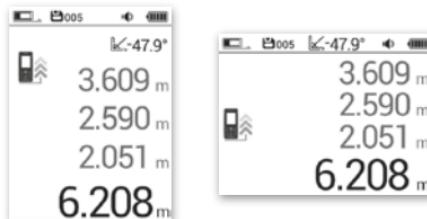
Il dispositivo ruota automaticamente il contenuto dello schermo in base all'orientamento corrente. Supporta una rotazione completa di 360° e visualizza in quattro direzioni.
